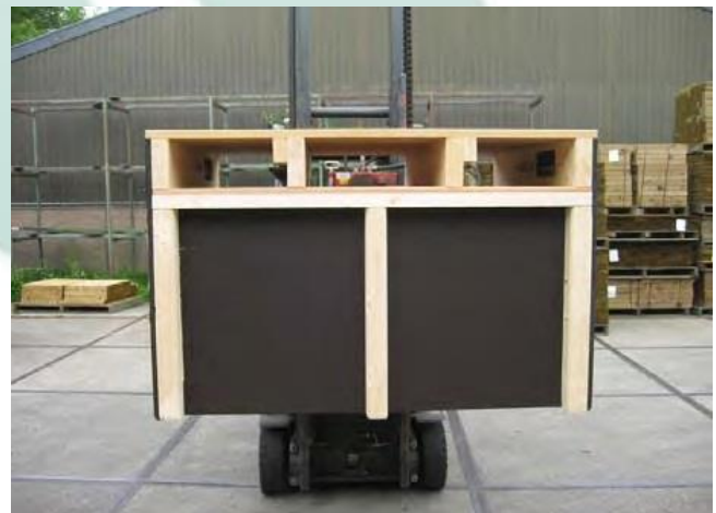
La caja no se puede mover entre las vigas. No se puede dañar el palet. La dosificación de las semillas ocurre fluidamente.
