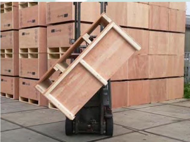
Por la estructura del palet, el apilador puede volcarlo sin peligro.
