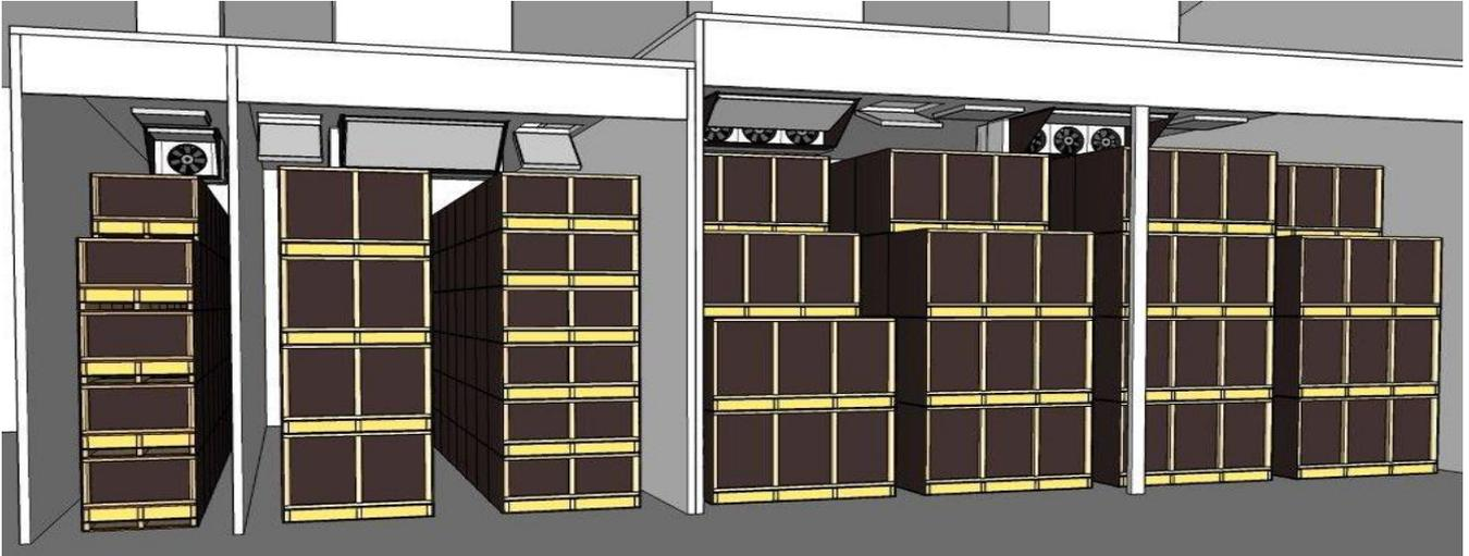
Dependiendo del requisito y el uso, se determinan la división y las medidas de las células; 1 o más filas de cajas por célula o 1 célula grande con el secado a los 2 lados, 3-4-5-6 cajas apiladas en alto. Volúmenes de hasta 30 o 40 m<sup>3</sup> por fila son posibles.
