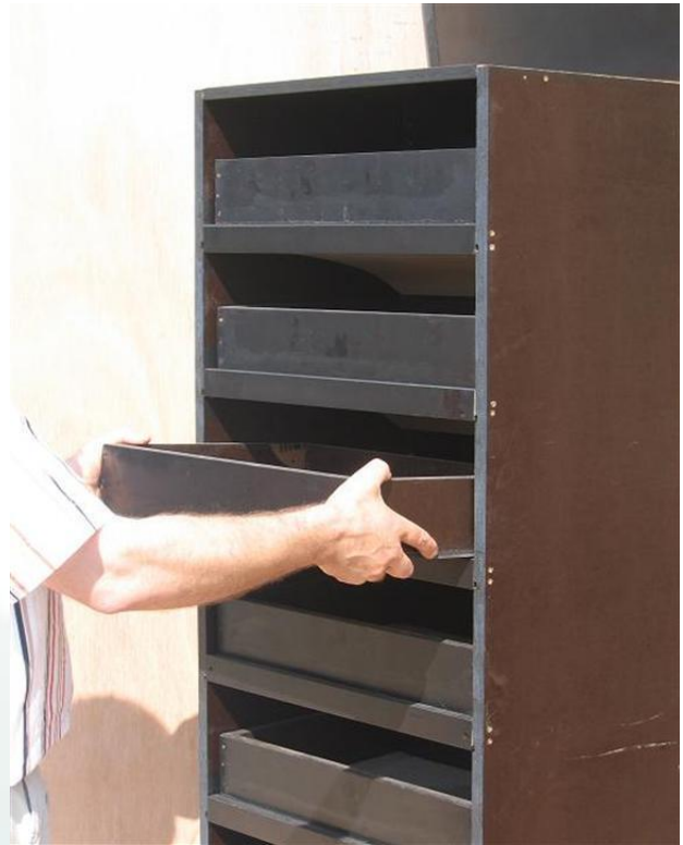
Entrada de aire se abre cuando se coloca el cajón.
