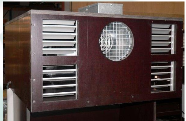
Unidad de extracción, incluyendo calentador y válvulas.
